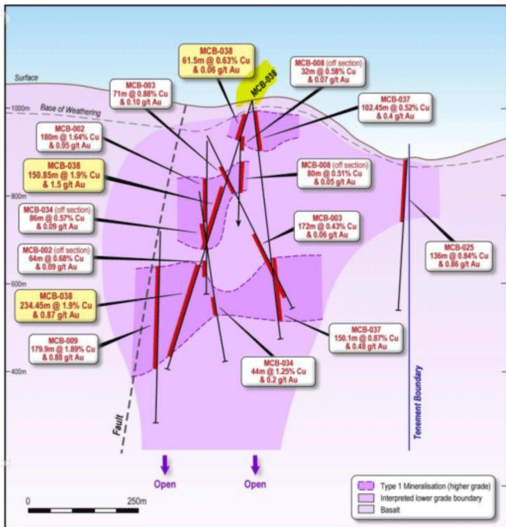
Schauen wir uns den Querschnitt an (siehe oben). Die Bohrung wurde so angesetzt, um durch drei bereits bekannte Zonen zu stoßen. Es ist also kein neuer Fund, sondern eher ein "sicheres Bohrloch", bei dem man grundsätzlich mit guten Treffern rechnen konnte. Es ist aber nicht so, dass man "nur" ein paralleles Loch gebohrt hat, sondern die Bohrung liegt schon von den früheren entfernt und wurde auch in einem anderen Winkel angesetzt.
