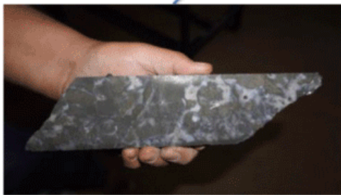
Foto 4 - SM20-44 Bohrkern einer hydrothermalen Quarz-Sulfid-Brekzie
