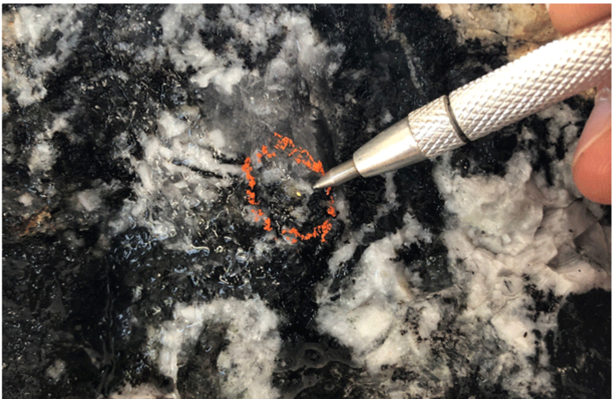
Das sichtbare Gold auf dem Bild oben stammt aus Grube A (westlichstes Grube) und befindet sich in einer pegmatitischen Quarz-Albit-Biotit-Ader. Der Aufschluss, der an dieser Stelle gesprengt wurde, enthielt
