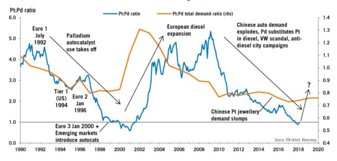
Der hohe Palladiumpreis in 2000/2001 setzte dieser Entwicklung ein Ende und Platin wurde wieder verstärkt in Benzinkatalysatoren verwendet, während der Einsatz von Palladium im Elektronikbereich drastisch zurückging (Substitution in MLCCs - "Multi Layer Ceramic Capacitators"). Für die nächsten 10 Jahre handelte Platin dann meist höher als Palladium, da der Kauf von Dieselfahrzeugen in Europa im Zuge von Steuererleichterungen begünstigt wurde.
