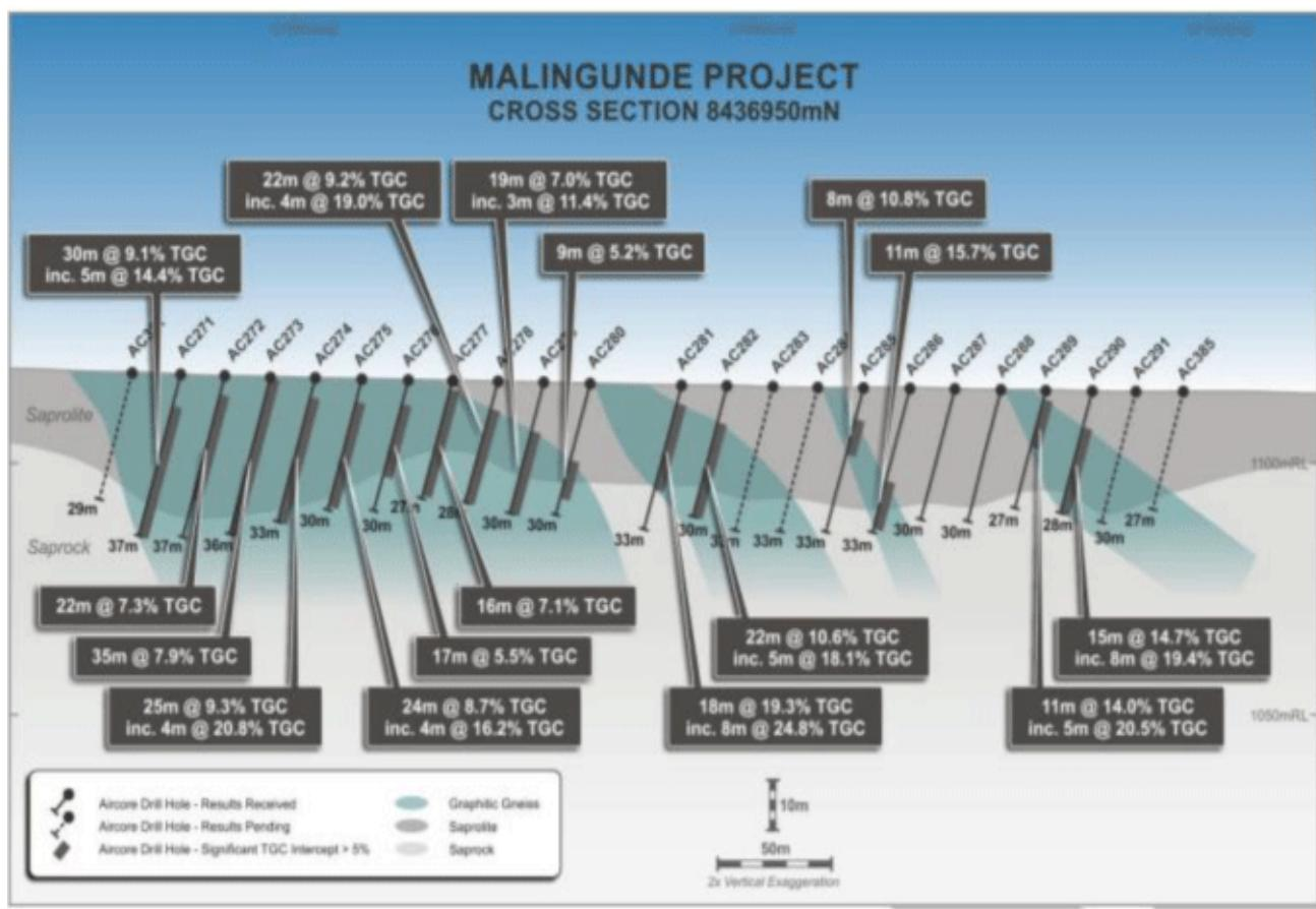
Die Vorteile eines solchen Gebietes sind fantastisch. Erstens gibt es nur eine dünne Deckschicht von wenigen Metern, die beim Abbau entfernt werden muss. Zweitens wird dann das Material (sehr weich) einfach mit dem Bagger abgebaut, ohne vorher Sprengen zu müssen.
