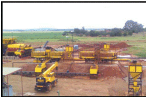
Abbildung links: Installation der vier 16-Fuß-Beckenanlagen Abbildung rechts: Rohdiamanten von der Tirisano Mine
