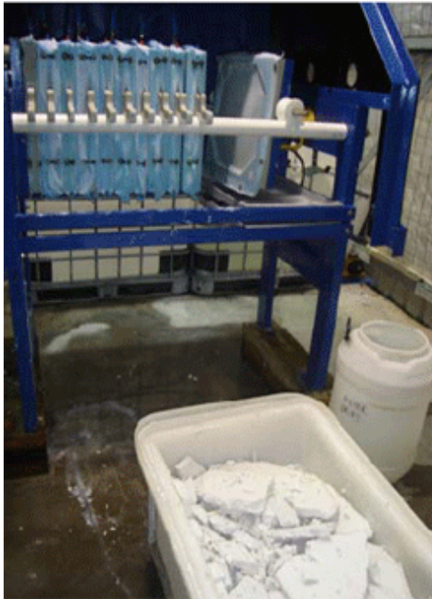
Darstellung links: Filtration des seltene Erdkarbonats in der Pilotanlage Darstellung rechts: Proben des seltene Erdkarbonats zur weiteren Analyse
