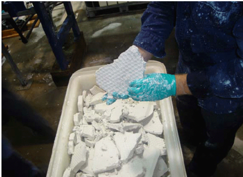
Pilotbruchstück des seltene Erdkarbonats aus einem einzigen Filterdurchlauf
