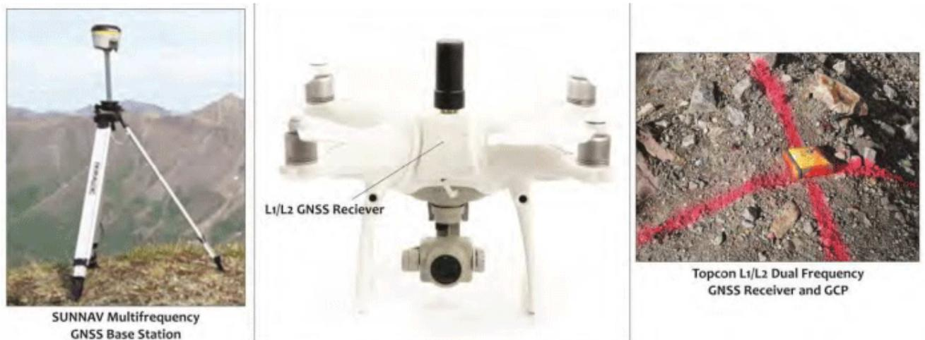
Die Daten der Bodenkontrollpunkte (GCP) wurden während der Untersuchung erfasst. Zur Untersuchung des Magnum-Ziels wurden 25 Geländeverfolgungsmissionen mit insgesamt 5.419 während der Untersuchung aufgenommenen Fotos durchgeführt. Die endgültige GSD (Auflösung) betrug 4,55 cm für das Orthomosaik und 18,2 cm für das digitale Oberflächenmodell (DSM).
